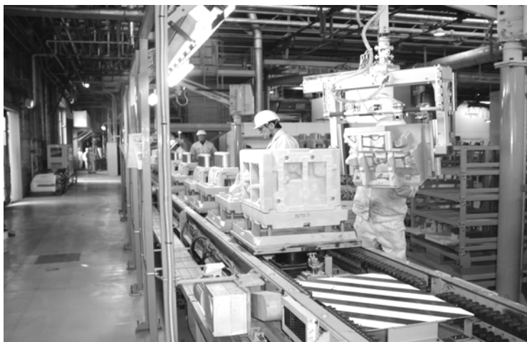
Рис. 3. Производство, сборка и подготовка к заливке стержневых форм на заводе концерна «Mazda» в г. Хиросима (Япония)
