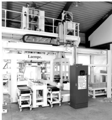
Рис. 1. Общий вид пескострельного центра «Laempe» для изготовления стержневых форм
